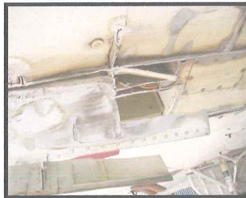
Fotografía No. 8 Vista de compuertas del tren dañado
