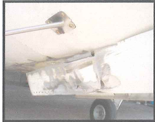
Fotografía No. 10 Vista 2 de compuerta de tren de nariz dañada
